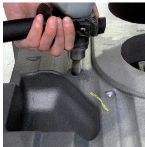
Příprava pro návár vyvrtáním
