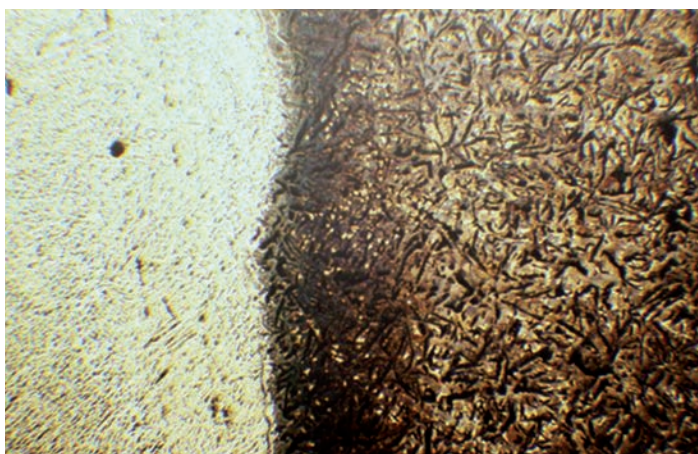
svar el. obloukem s elektrodou E-S716 (50%Ni) 4 vrstvy, roztémování a kartáčování každé vrstvy čekání na vychladnutí každé vrstvy – cca 40 min.
